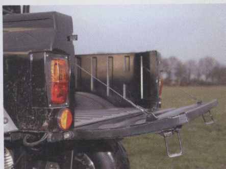
▲ De laadbak is 110 cm breed en 90 cm lang. Een lengte van 130 cm is een optie.
